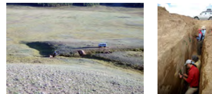
Figure 3 : (gauche) talweg déplacée d'une vingtaine de mètres le long de la faille de Bolnay (noter la tranchée creusée au travers de la faille). (droite) Levé paléosismologique dans une tranchée
